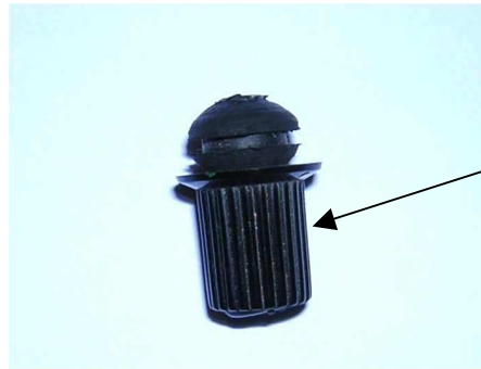
Assemblage du passe câble et bouton de commande emmanchés sur l'entretoise
