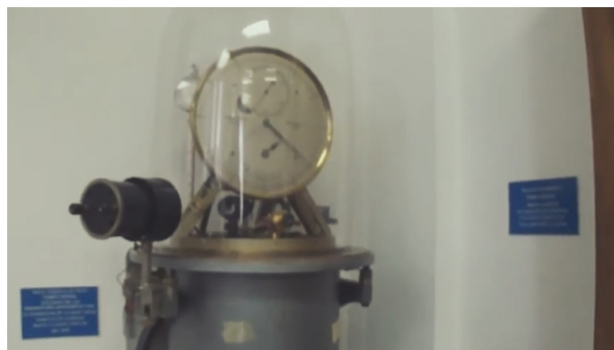
Aqui podemos dar uma olhada mais de perto em um relógio de pêndulo a vácuo, em tempo sideral, usado em observações astronômicas para a correção do tempo legal, Fabricação alemã, marca Clemens Riefler ano 1955.
