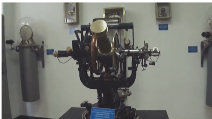
Aqui podemos ver um belo teodolito universal AUZ-27, instrumento astronômico para determinar a época, de fabricação alemã, marca askania werke, ano 1935.
