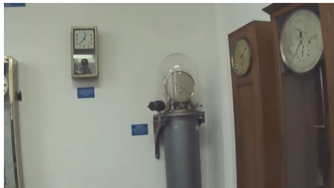
Aqui podemos ver à esquerda 2 relógios de pêndulo a vácuo, em tempo sideral, utilizados em observações astronômicas para a correção do tempo legal, Fabricação alemã, marca Clemens Riefler ano 1955.
