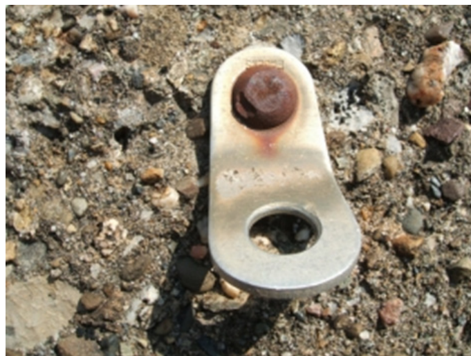
3 - Presilha de aço revestido com cadmio fixada por parafuso de aço.
