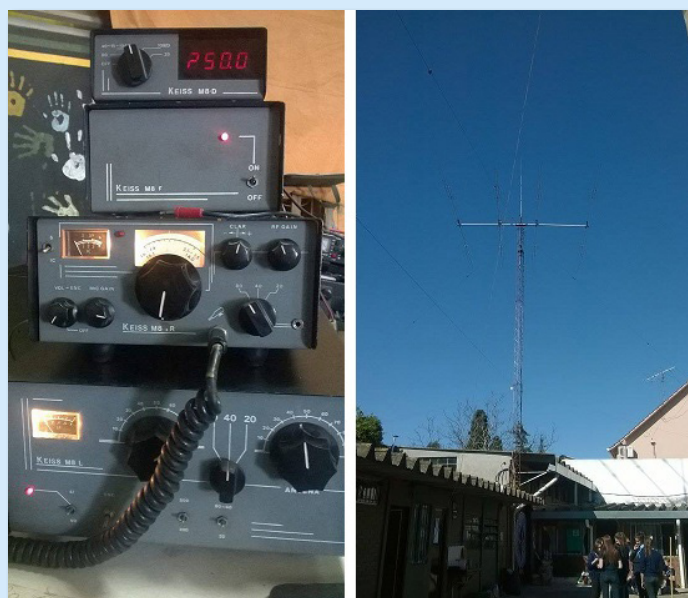
À esquerda podemos ver o transmissor da marca argentina Keiss e à direita a antena Yagi de 4 elementos para HF, utilizada no evento.
