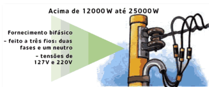
12 - Entrada de rede bifásica
