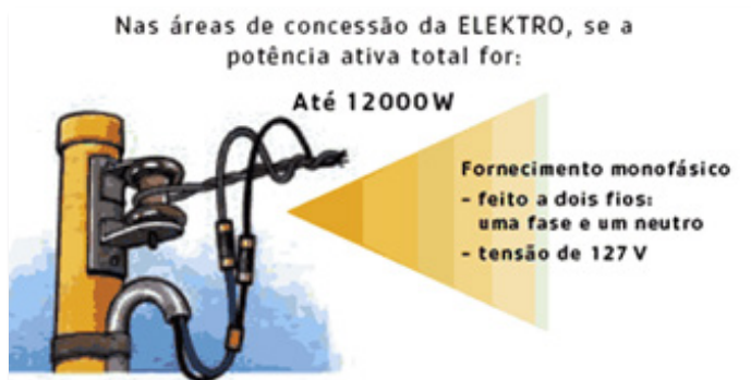
11 - Entrada de rede monofásica
