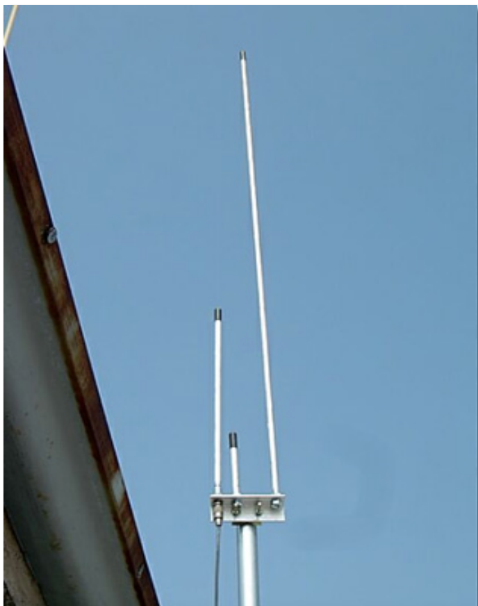
62 – Antena J-pole para 144 e 440 MHz
