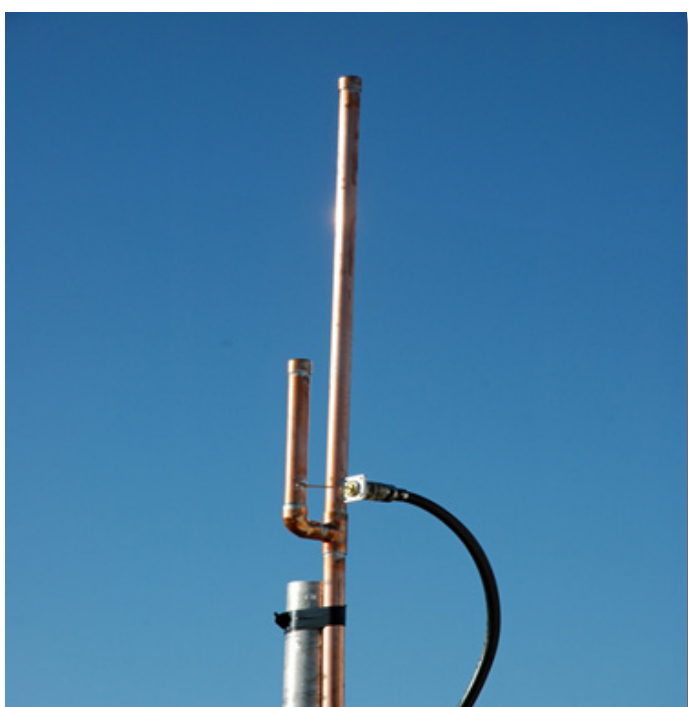
64 – Antena J-pole para 440 MHz
