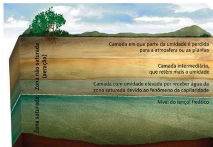
36 – Perfil mostrando os vários tipos de camadas do solo
