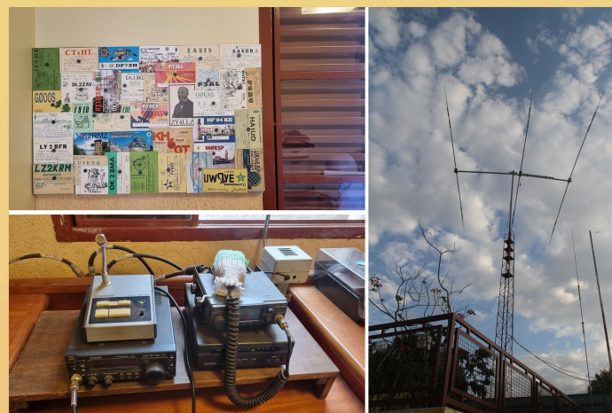
Estação de Eni (PT2CA), simples mas muito eficaz, podemos ver um Transmissor HF Kenwood TS-50S, em conjunto com um transmissor VHF analógico, onde mantém QAP no repetidor da cidade. Também podemos ver um quadro com mais QSLs de colegas e estações especiais em Esperanto. Finalmente você pode ver sua antena Yagi de 3 elementos se preparando para seu próximo DX
