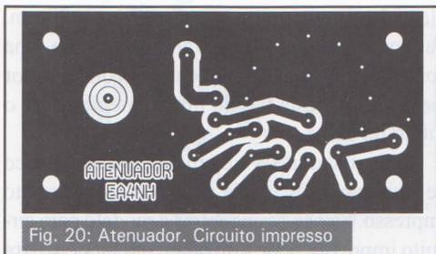
Fig. 20: Atenuador. Circuito impresso
