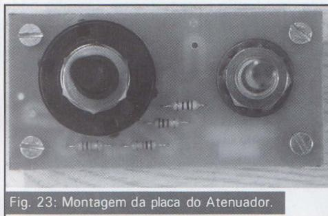
Fig. 23: Montagem da placa do Atenuador.
