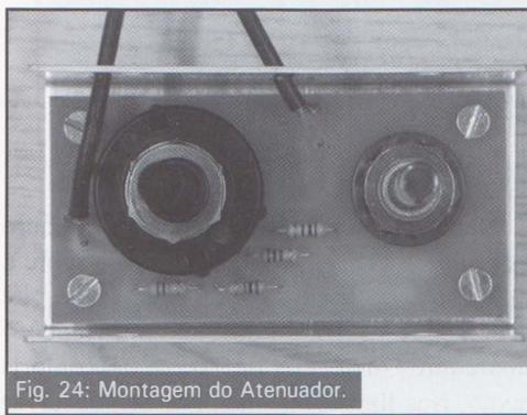
Fig. 24: Montagem do Atenuador.
