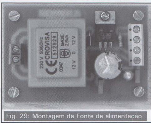
Fig. 29: Montagem da Fonte de alimentação
