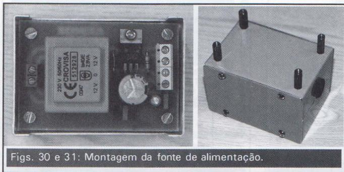
Figs. 30 e 31: Montagem da fonte de alimentação.
