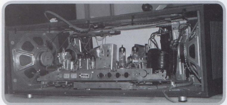
*[Na imagem acima, vista da parte traseira podendo observar-se o sistema de revêrbero entre o fundo da caixa e o chassis]*
