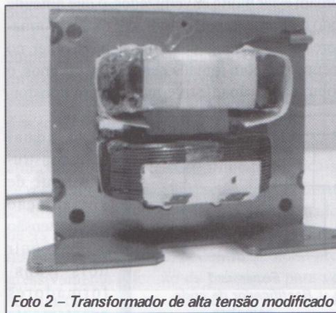
**Foto 2 – Transformador de alta tensão modificado**
