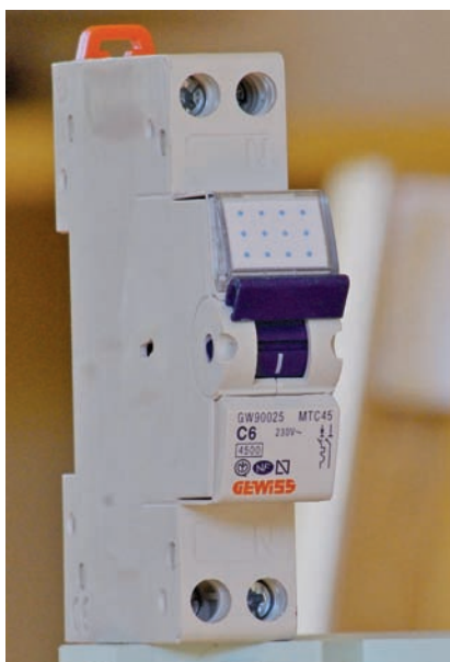
Fig. 3 - Magnetotermico C6 di produzione Gewiss. È solo un magnetotermico, niente differenziale. La portata di corrente bassa, 6 A, lo rende adatto ai circuiti luce puri, senza prese da 10 A, che ne saranno ampiamente protetti.
