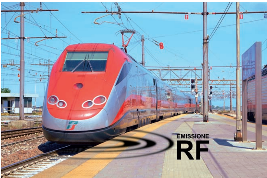
Fig. 1 - Ogni locomotore integra un trasmettitore RF la cui antenna è alloggiata nella parte inferiore della scocca. L'emissione è attiva quando la motrice è impegnata nella movimentazione o nelle fasi di manovra di un convoglio.
