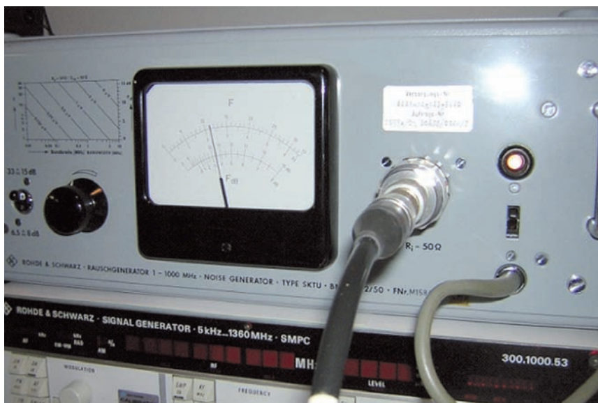
Foto 5 - Misura della cifra di rumore con il generatore SKTU
