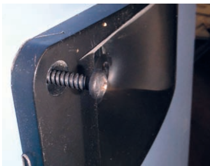
Fig. 8 - Dettaglio del fissaggio con vite da legno del tweeter
