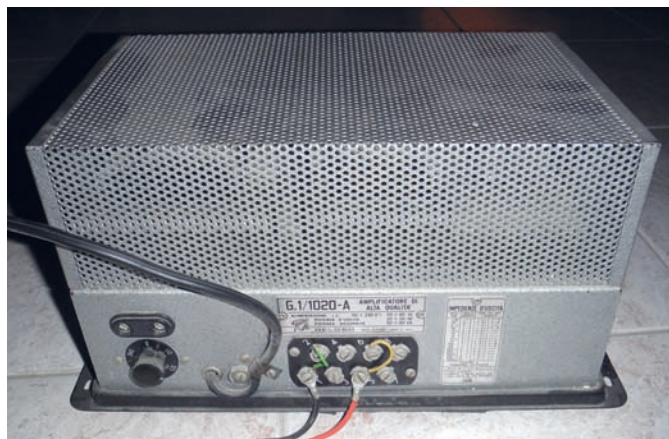
Fig. 18 - Vista posteriore dell'amplificatore Geloso G.1/1020-A e del cablaggio dell'uscita per 8 Ω
