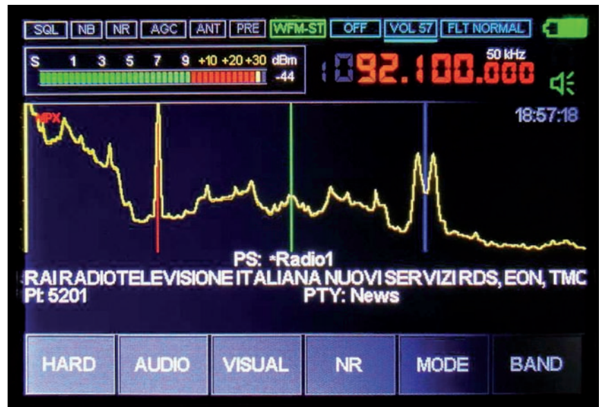
Spettro MPX con i dati dell'RDS: PS, PI, PTY.
