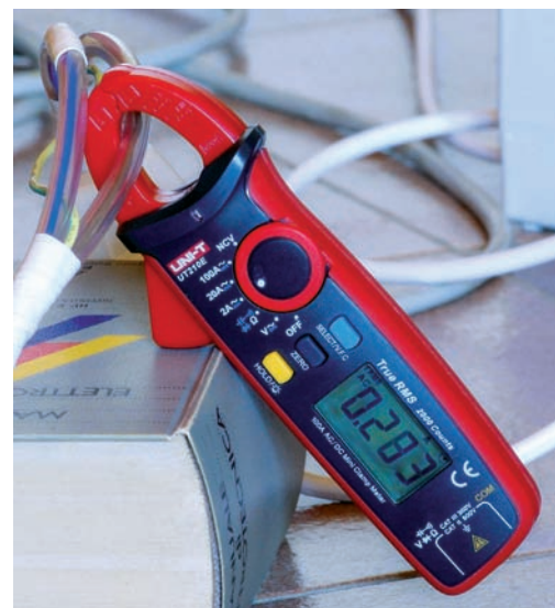
Fig. 3 - Piccola pinza amperometrica AC-DC UT210E, di produzione UNI-T. Lo strumento è abbastanza sensibile, 2 A fs, ma per le correnti di dispersione sarebbe meglio una portata di 200 mA
