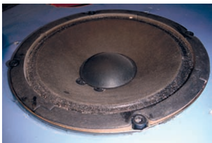
Fig. 9 - Il woofer fissato alla cassa con viti metriche e dadi a ragno
