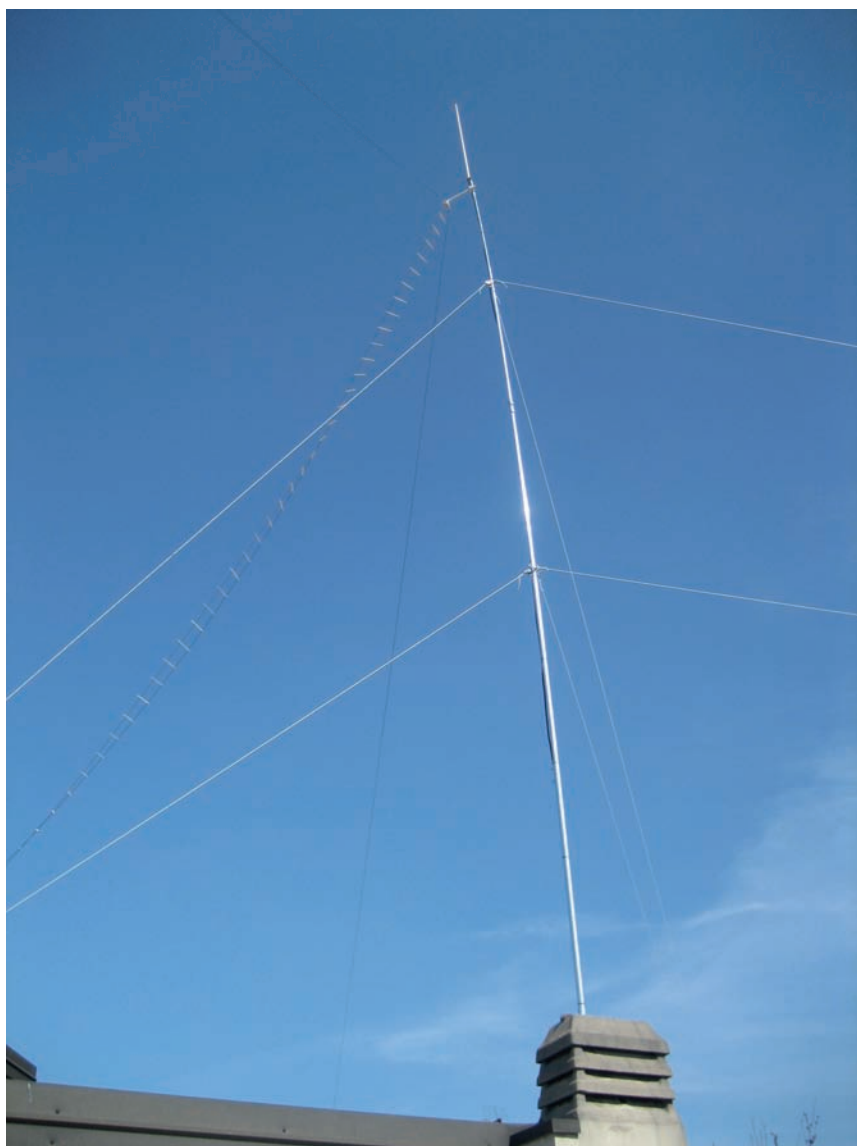
Fig. 8 - Doublet da 42m alimentata da linea bifilare autocostituita con le targhette per giardinaggio. La linea scende "ad elica" in modo da essere insensibile al vento.
