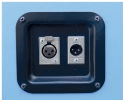
Fig. 12 - Dettaglio del pannello con le connessioni XLR
