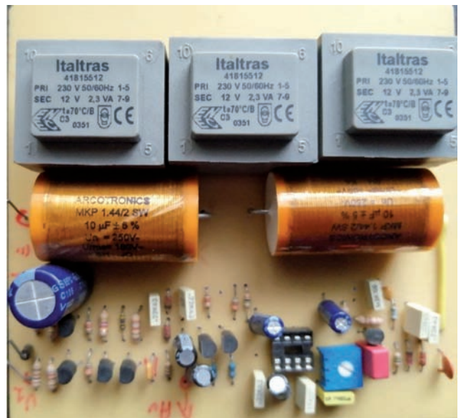
Uno dei primissimi ricevitori dedicati allo studio dei PSE messi a punto da I5JRV
