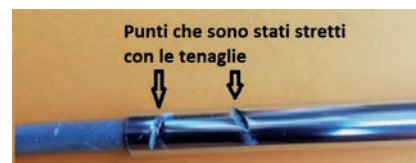
Fig. 6 - bloccaggio dei prolungamenti degli elementi
