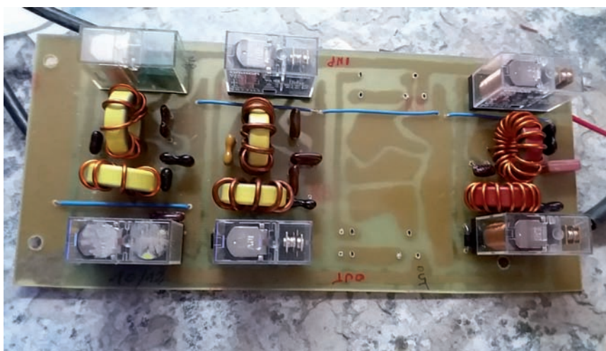
Fig. 16 - Filtri ellittici e relay di commutazione.
