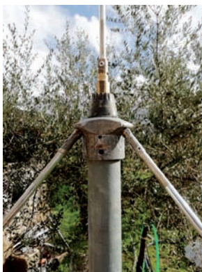
Fig. 8 - Particolare che mostra lo stilo e i radiali avvitati sul nucleo
