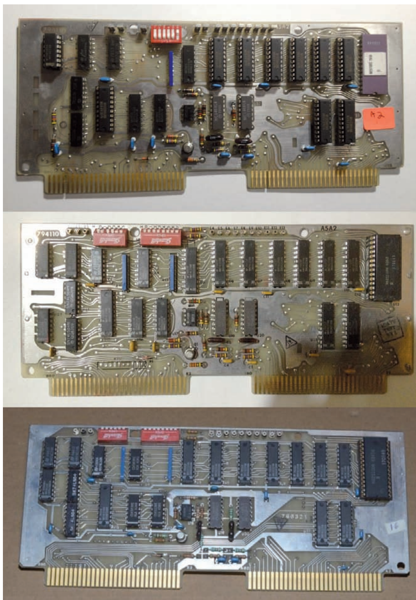
Fig. 12 - Confronto delle schede A5A2 Synthesizer Interface ("A" in alto, "B" al centro, "B-S1" in basso).
