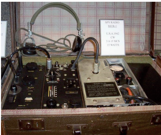
L'equipaggiamento completo si presentava circa così. Ricevitore a sinistra – trasmettitore – alimentatore – accessori e tasto telegrafico/cuffie
