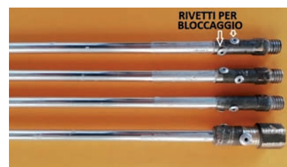
Fig. 4 - I tubetti di alluminio inseriti all'interno dei supporti
