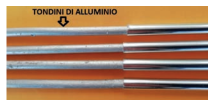
Fig. 5 - Prolungamento dei tubetti mediante tondino di alluminio
