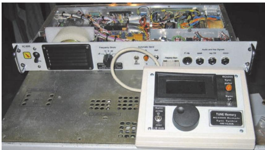
RC6000 con l'impostatore esterno di sintonia.
