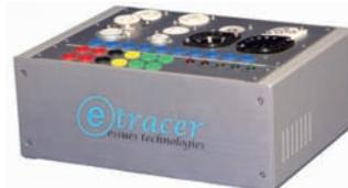
Le straordinarie specifiche di etracer possono essere raggiunte in modo efficiente grazie all'impiego delle moderne tecnologie quali l'alimentatore switching, i dispositivi a semiconduttore ad alta tensione e i microcontrollori ad alta velocità. A differenza dei tradizionali provavalvole, etracer utilizza brevi impulsi di stimolo per caricare un condensatore che viene poi collegato all'elettrodo opportuno del tubo a vuoto in prova durante gli impulsi di misurazione. Il cuore di
