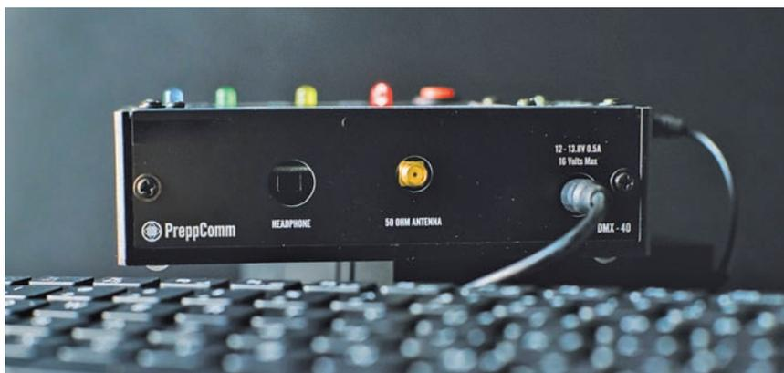
se alimentato a 12 volt. Se infatti desidererete utilizzare il DMX-40 anche su altre bande, non temete. Passando in "external mode", sarà possibile connettersi a qualsiasi altra radio dotata di uscita per cuffie e ingresso per tasto CW operando così su tutte le gamme dell'apparecchiatura esterna. Io stesso ho collegato il DMX-40 al mio Yaesu FT-991A e mi sono divertito un mondo operando in CW come se fosse parte integrante del transceiver.
