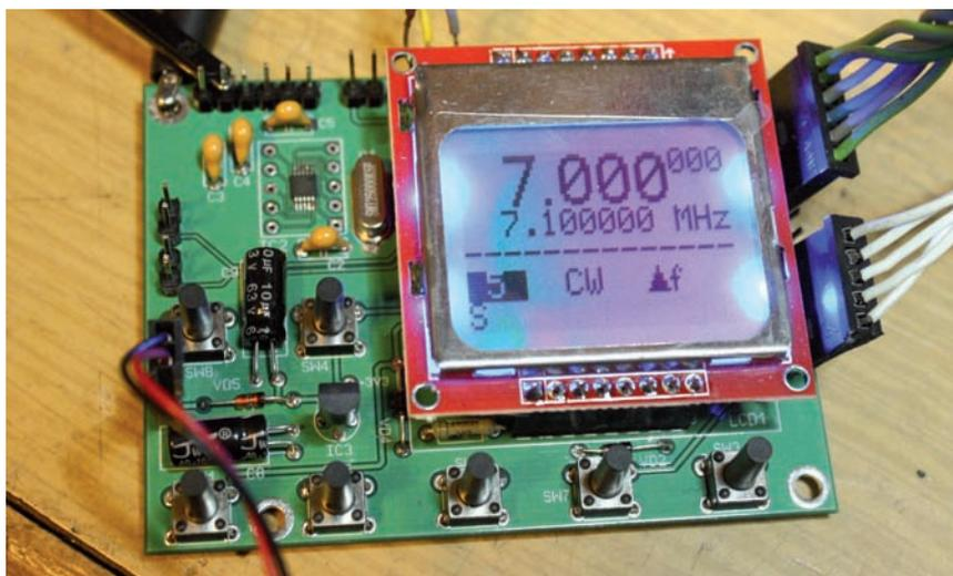
Foto 2 - Il generatore DDS montato e in funzione
