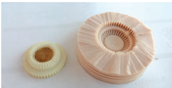
Foto 11 - Vecchio ingranaggio e relativo stampo
