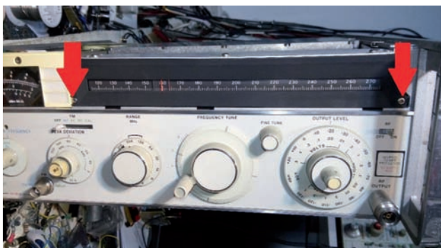
Foto 6 - Viti che fissano superiormente la cornice in plexiglas
