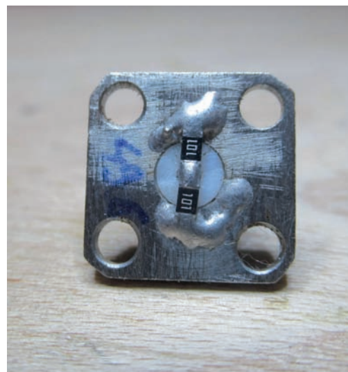
Figura 3 – Carico per calibrazione da 50 \Omega realizzato artigianalmente con due resistori SMD da 100 \Omega in parallelo saldati sul retro di un connettore SMA da pannello.
