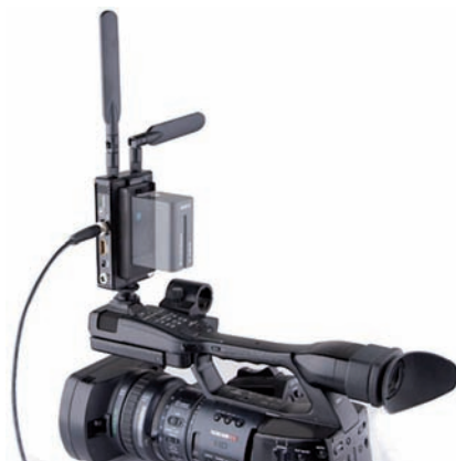
Fig. 3 - Un modem trasmittente WHDI per link wireless montato sopra una telecamera professionale
