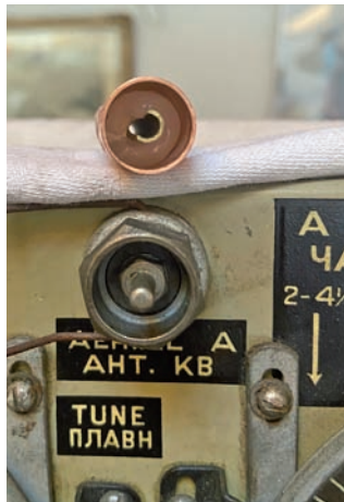
Foto del connettore con primo fissaggio con silicone
