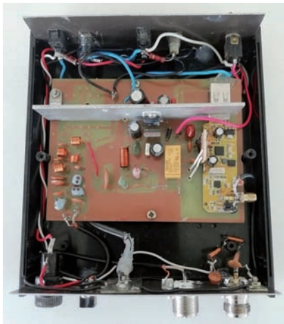
Fig. 13 - Interno del RX, realizzato con chiavetta non predisposta. DA ALIMENTARE ESTERNAMENTE
