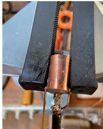
Preparazione del connettore con bloccaggio cavo RG58 con profilato di ottone a sezione quadrata 1mm
