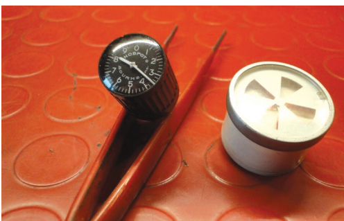
Foto 10 - Potenziometro multigiri e indicatore a croce
