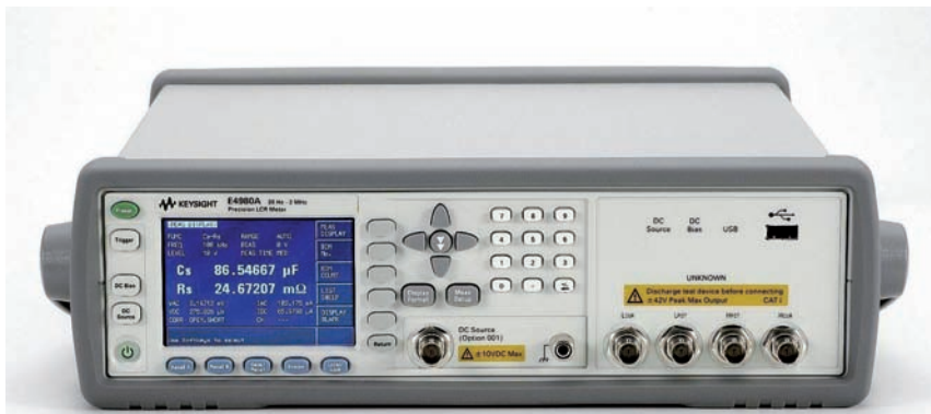
Fig. 3 - Il Keysight E4980A, strumento di gran classe, come tutti i prodotti dell'azienda che in passato fu HP Divisione Misure e poi Agilent. Fa misure di ottima accuratezza da 20 Hz a 2 MHz
