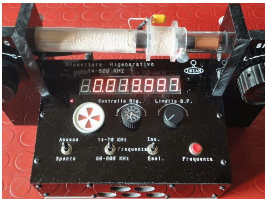
Foto 14 - Pannello frontale, avvolgimento LB e LC
