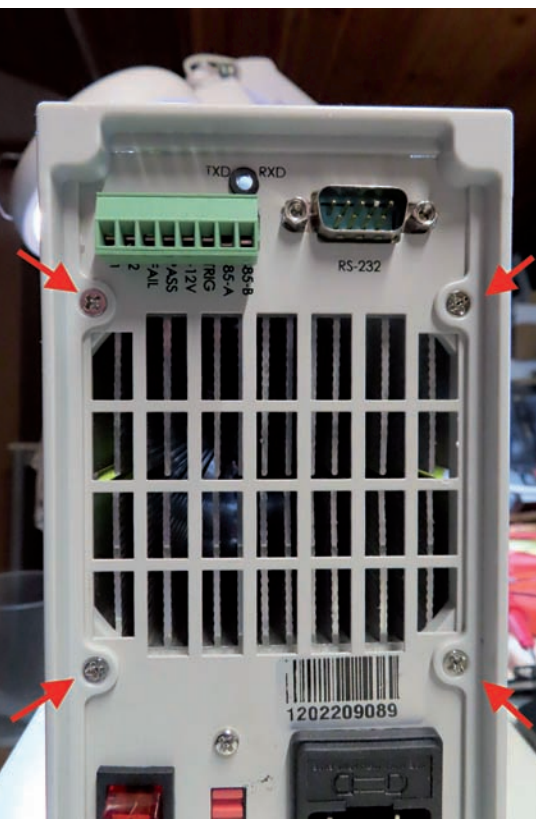
Figura 9 - Le quattro viti sul retro sono avvitate sul dissipatore, che è elettricamente collegato al polo positivo sull'ingresso frontale. Pertanto, su queste quattro viti troviamo il positivo della tensione sotto carico, che, secondo specifiche dell'apparecchio, può arrivare a 150 V.
