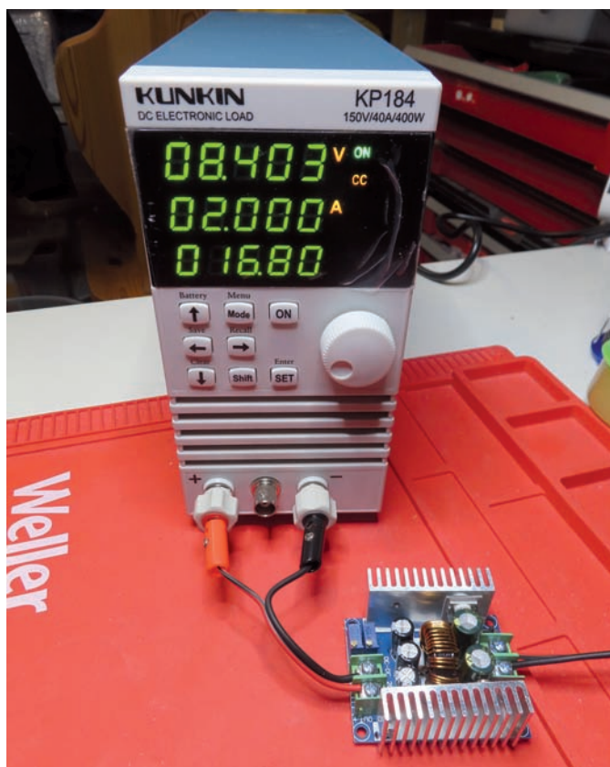
Figura 1 - Carico DC mentre "stessa" un economico convertitore DC-DC per verificare quanta corrente possa essere effettivamente prelevata al di là dalle ottimistiche dichiarazioni di targa.
