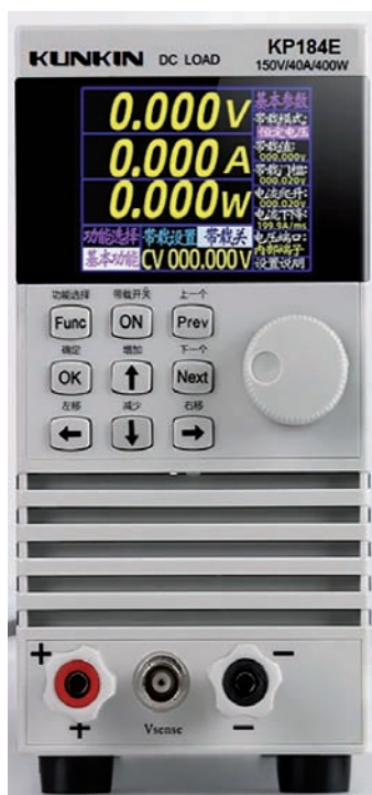
Figura 2 - Versione del KP184 con display LCD. Con questa versione è più semplice entrare nei (pochi) menu presenti nell'apparecchio.
