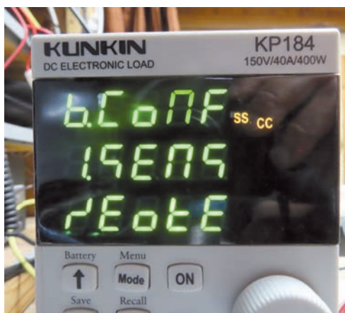
Figura 3 - La comprensibilità dei menù, ottenuti con il display a sette segmenti, è alquanto bassa. Per operare è necessario avere il manuale a portata di mano.
