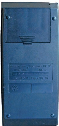
Retro della MK-61. In alto il vano batterie, tre celle AA per un consumo dichiarato di 600 mW.
