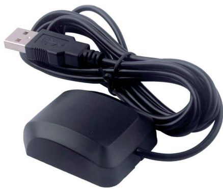
Figura 3 - Dispositivo GPS con connessione USB, normalmente chiamato "GPS mouse". È un normale modulo GPS collegato a un convertitore seriale-USB. Raramente questi dispositivi dispongono di segnale 1 PPS.
