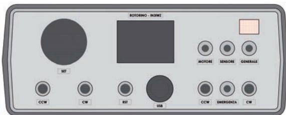
Figura 11 - Disposizione di comandi e schermo OLED sul pannello frontale
