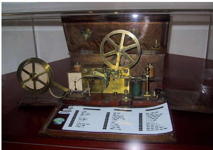
Foto 3 - Modello di ricevitore telegrafico di Morse del 1837 (Collezione storica "France Telecom")
