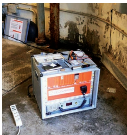
Foto 7 - Installazione di un ripetitore mobile presso la torre di un acquedotto
