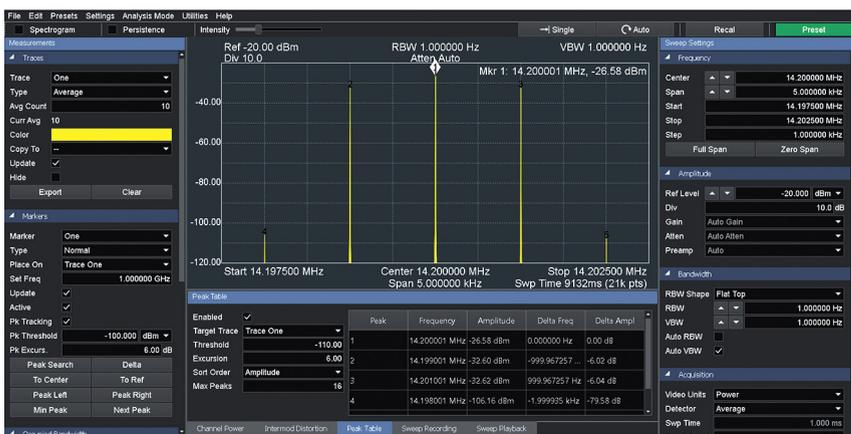
Figura 4 - Segnale a 14,2 MHz modulato al 100% in AM a 1 kHz
