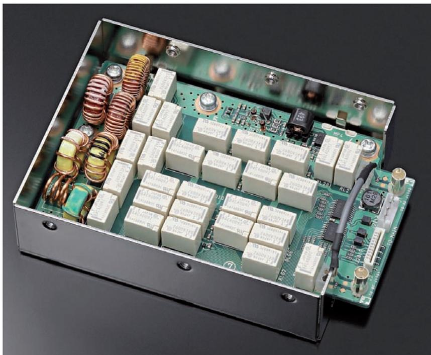
**Figura 2 – Il modulo preselettore RF dell'apparato IC-7610, circuito che esalta l'alta dinamica delle sue due sezioni riceventi. Si osservi la dominante presenza dei ventotto relè adibiti alle rete di commutazione degli induttori e condensatori che implementano il filtro.**
