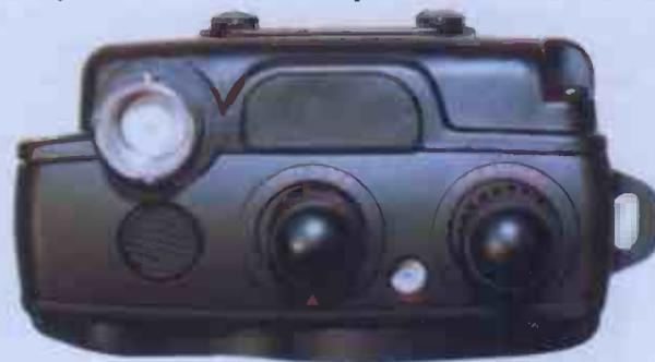
En esta vista superior del equipo podemos destacar el conector BNC para la antena, el mando del silenciador, y los potenciómetros para el ajuste del volumen y selector de canales.
