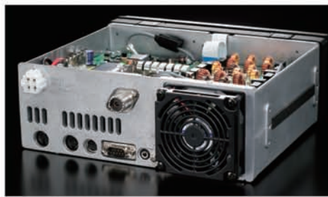
Chasis en fundición de aluminio con ventilador
