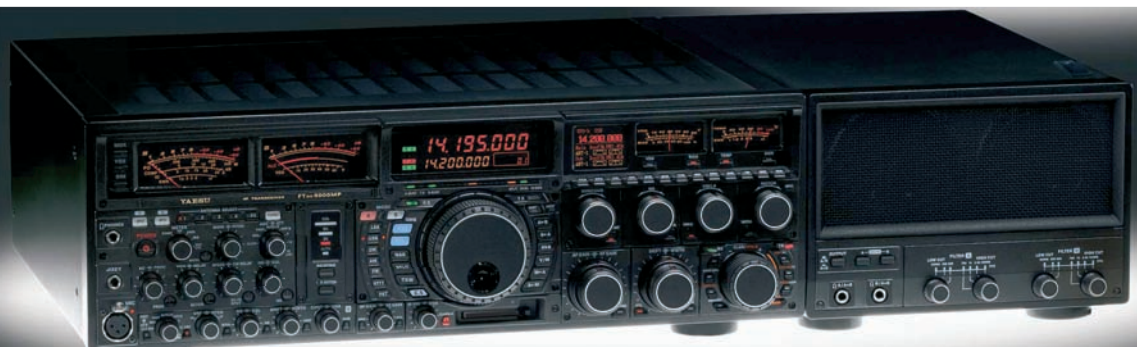
TOP El espectacular FTDX9000 presenta una primera FI más baja que el FT-2000. Ambos comparten los mismos roofing de 15, 6 y 3 KHz.
