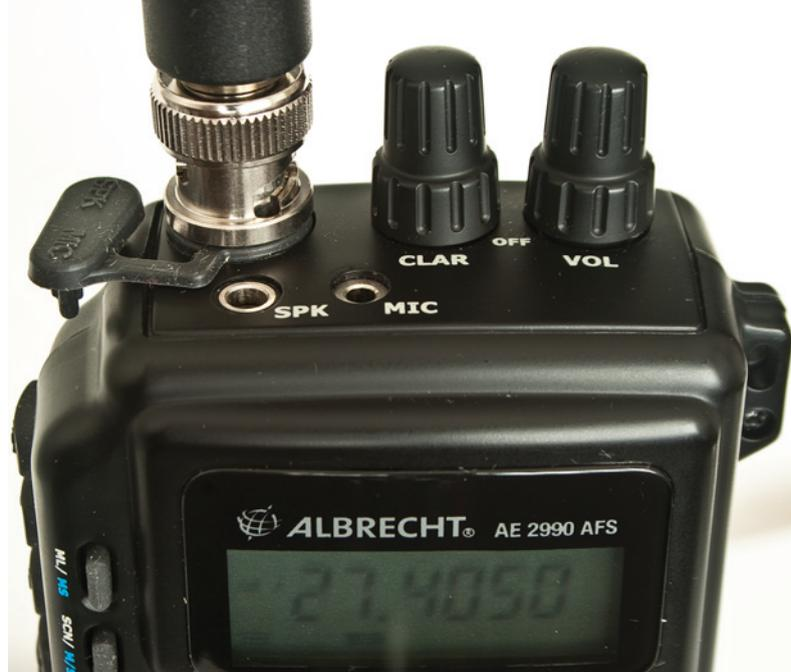
rior, además del conector BNC de la antena de porreta, están las tomas para micro y altavoz exteriores, el clarificador y el volumen. En cuanto a la antena, es evidente que con una de móvil o de base se obtienen mejores prestaciones, pero para uso como portátil hay
