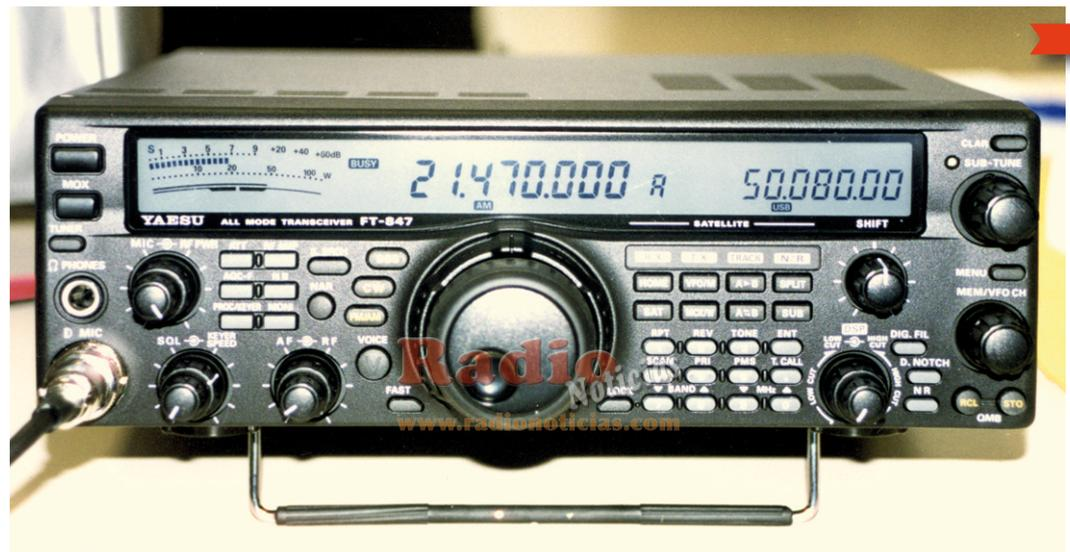
para 430 MHz, con lo que los operadores que emplean lineales tienen menos problemas a la hora de dejarlos permanentemente incorporados, además de que el equipo separa las líneas de control T/R representadas por transistores de colector abierto (circuito abierto en recepción y derivado a tierra en transmisión).
