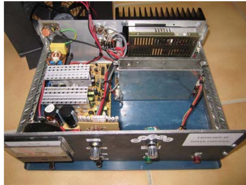
En la fotografía superior y en las dos de la derecha se aprecia el sistema de alimentación interna y ventilación de este amplificador.
