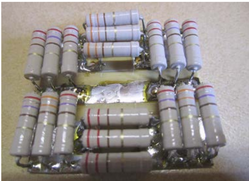
Elementos y montaje del atenuador de potencia. En la fotografía de la derecha el conjunto montado y listo para instalar en la caja del amplificador.
