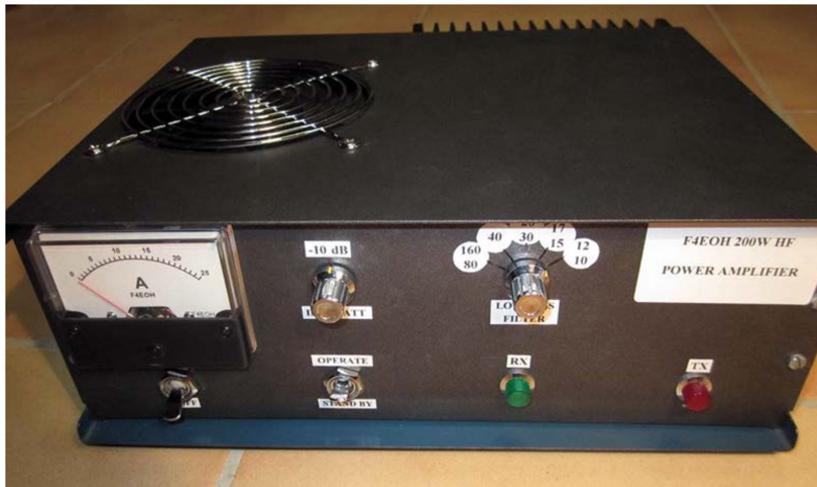
El amplificador completamente terminado y listo para transmitir. La potencia de salida es de 200 vatios.
