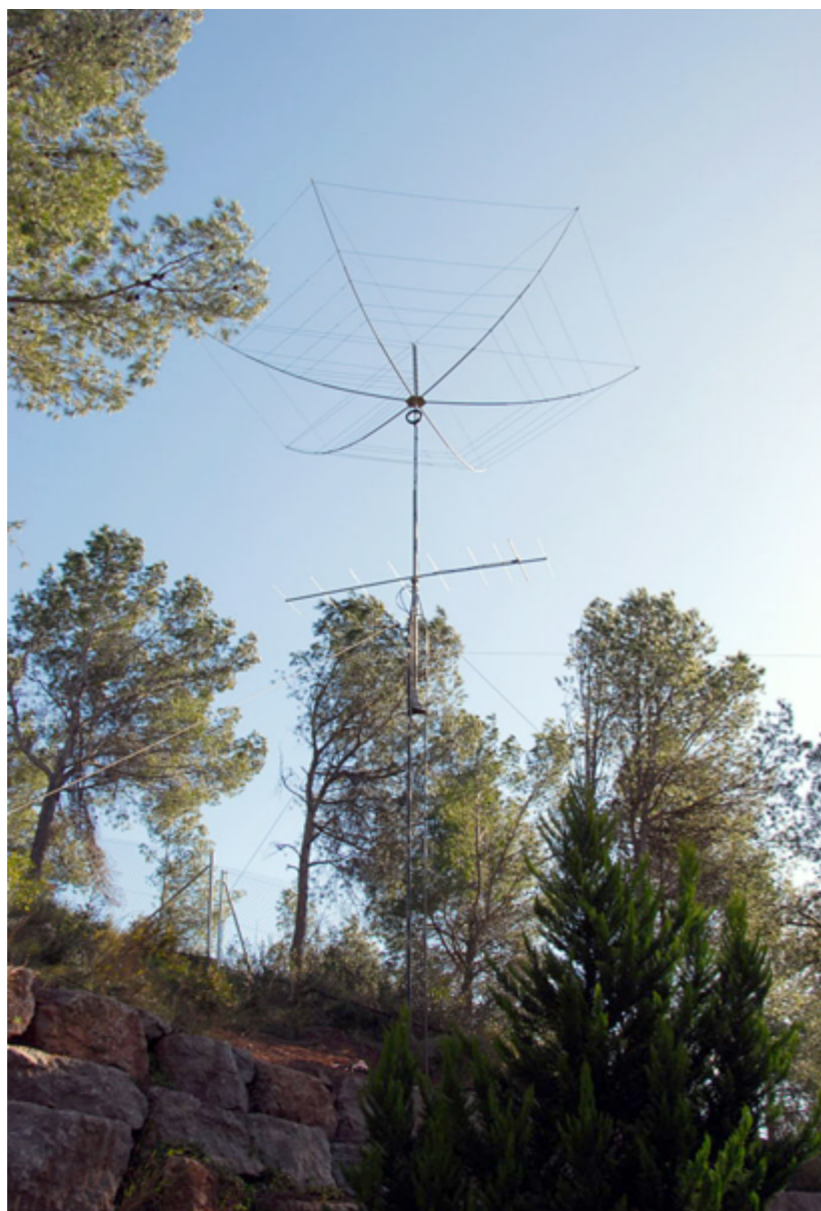
ANTENA Una de las antenas utilizadas por David (EA3FYZ), es una directiva multibanda basada en una idea de G3TXQ, un radiante al que califica de «una joya».
