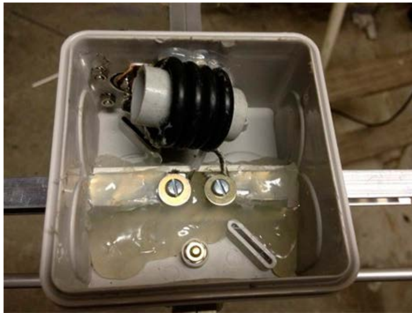
El choque balun, un tubo de 2 centímetros de diámetro por 3 de largo, con cuatro espiras de RG58.
