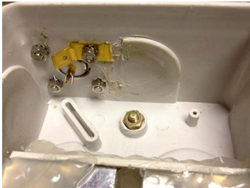
El conector N sólidamente fijado mediante cuatro tornillos.
