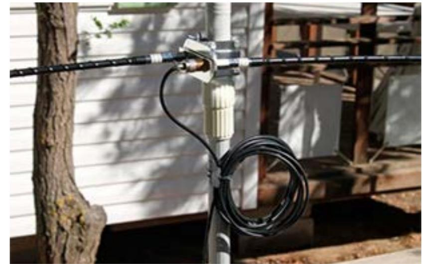
Detalle de la parte central con el coaxial.
