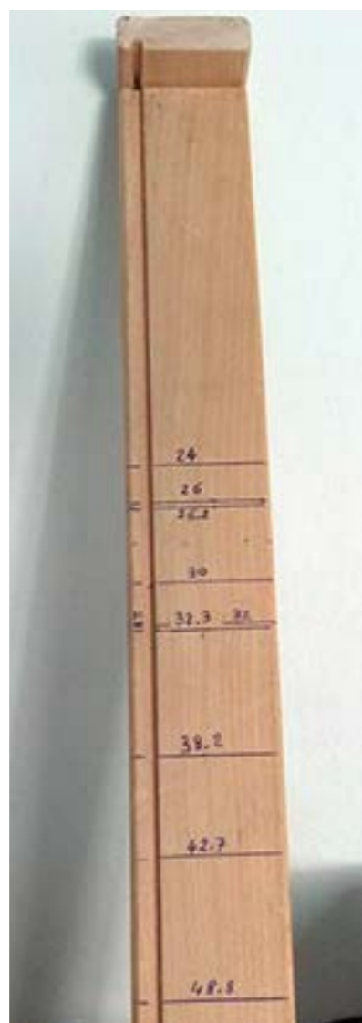
Una tablilla de madera con las marcas correspondientes a cada medida es muy útil para poder cortar los tubos correctamente y en poco tiempo.
