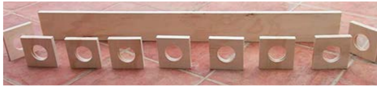
En un contrachapado marino se cortan 10 cuadrados y se les hace un orificio de 50 milímetros para reforzar el soporte principal.
