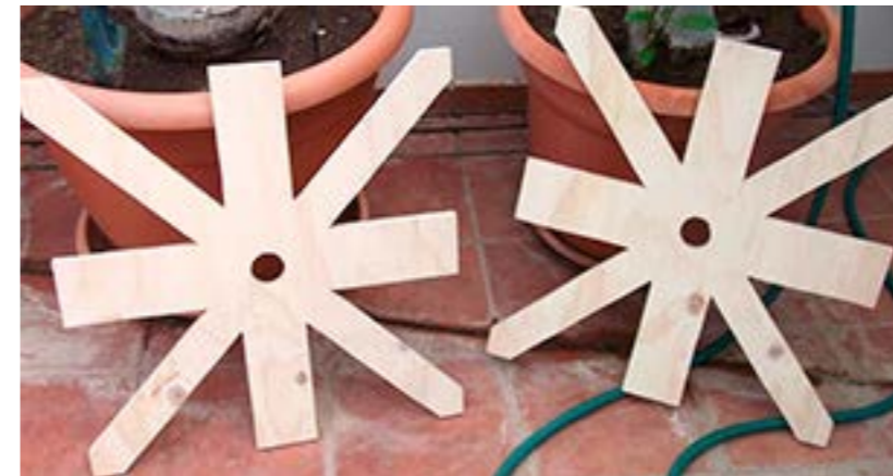
Soporte principal al que habrá que aplicar fibra y resina epoxy.
