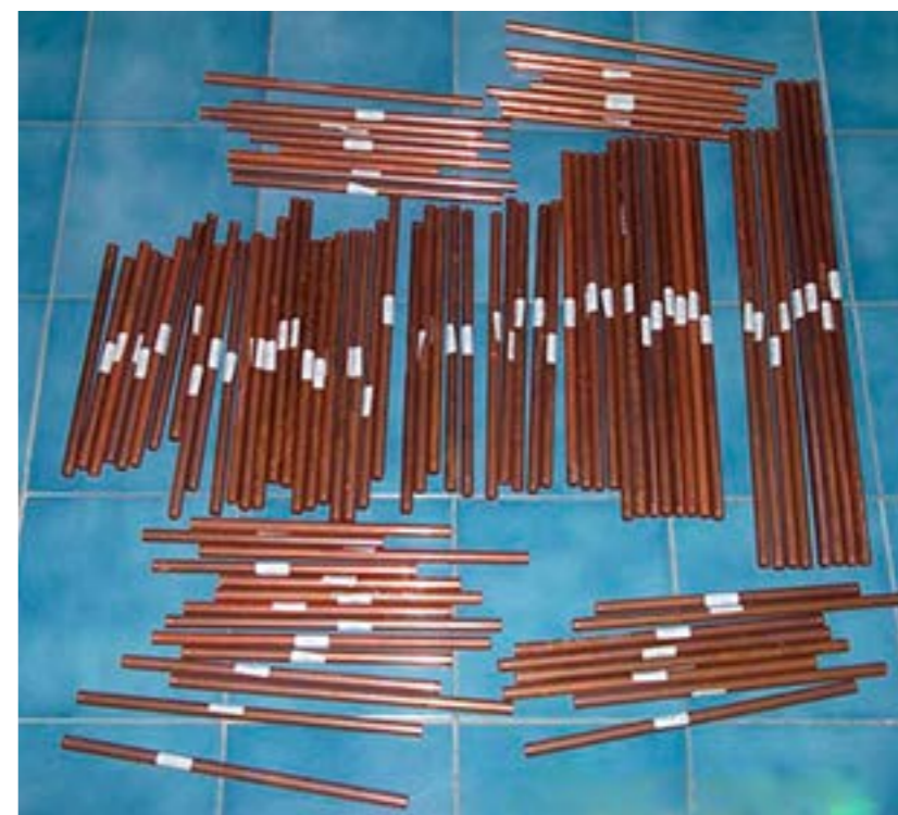
Los tubos marcados con etiquetas adhesivas y listos para su ensamblaje. Para limpiarlos lo mejor es la lima (foto inferior).
