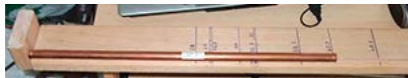
Uno de los tubos en la tablilla para ajustar la medida correcta y hacer el acabado final con la lima.
