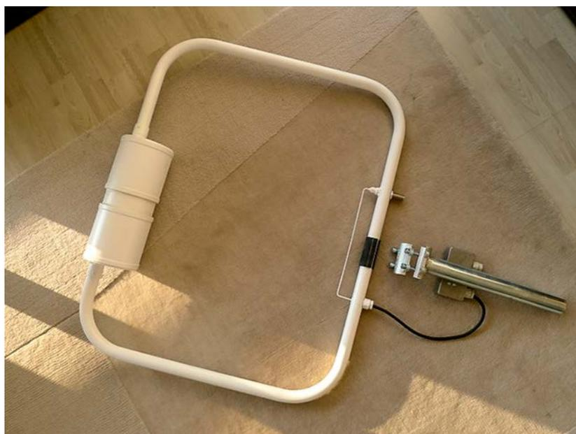
La ROE cambia en función de la potencia de emisión, algo normal puesto que la tensión aumenta en el condensador variable de acuerdo con dicha potencia (Tabla 2).
