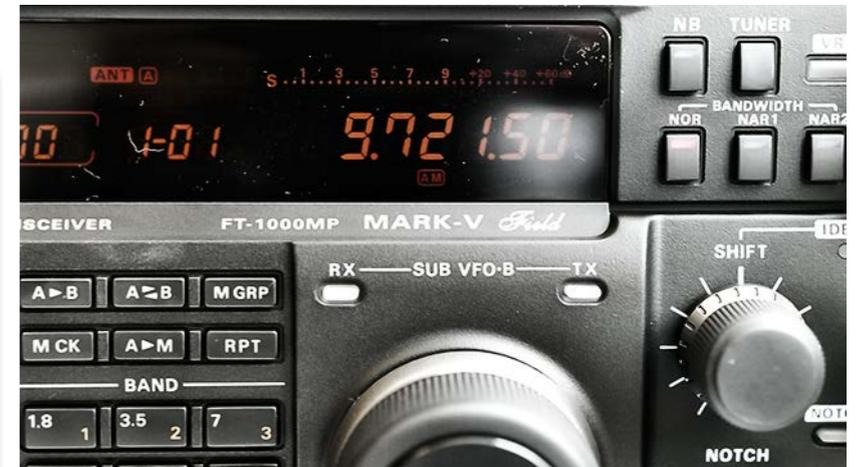
transmisión y en recepción; cuando el VRF está activo señala los picos del paso de banda estrecho; finalmente, los segmentos de la barra se expanden cuando se sintoniza en una dirección desde la frecuencia que refleja el frecuencímetro, dependiendo la relación y distancia del desplazamiento de dichos segmentos del paso de sintonía elegido.
