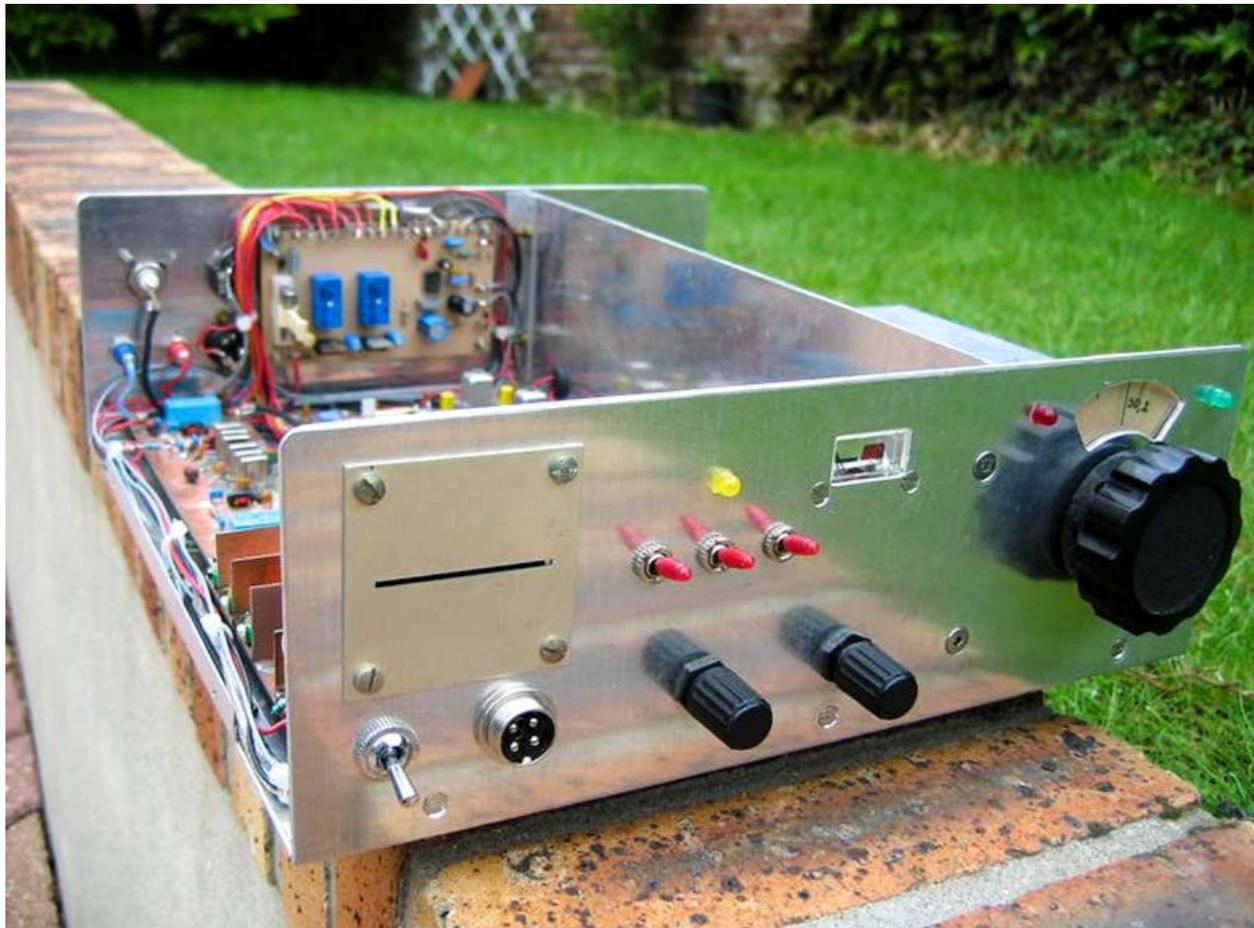
El transceptor de 50 MHz descrito en estas líneas es de concepción modular, todas las pletinas están unidas entre ellas por trozos de cable miniatura de 50 ohmios. Cada módulo puede así ser probado separadamente y también reemplazado por otro tipo de montaje. Por ejemplo, un amplificador FI de dos MOSFET BF960 puede sustituir al TCA440. El nivel del BFO es regulable, es posible ajustar el nivel de HF necesario para el buen funcio-
