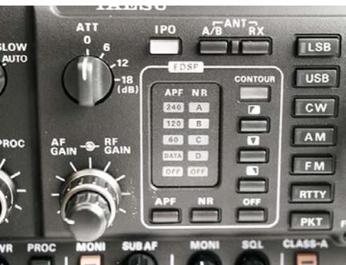
tercero entre 1,8 y 7 MHz. Cada uno de ellos entra en funcionamiento de forma automática cuando se cambia de banda, siempre que sea dentro de las frecuencias de aficionado, fuera de ellas conmuta directamente al de banda ancha. En caso de que haya interferencias en las frecuencias adyacentes, estos amplificadores *front-end* se inhabilitan con la función IPO, mejorando el rango dinámico y la distorsión de la modulación sin afectar excesivamente a la sensibilidad.
