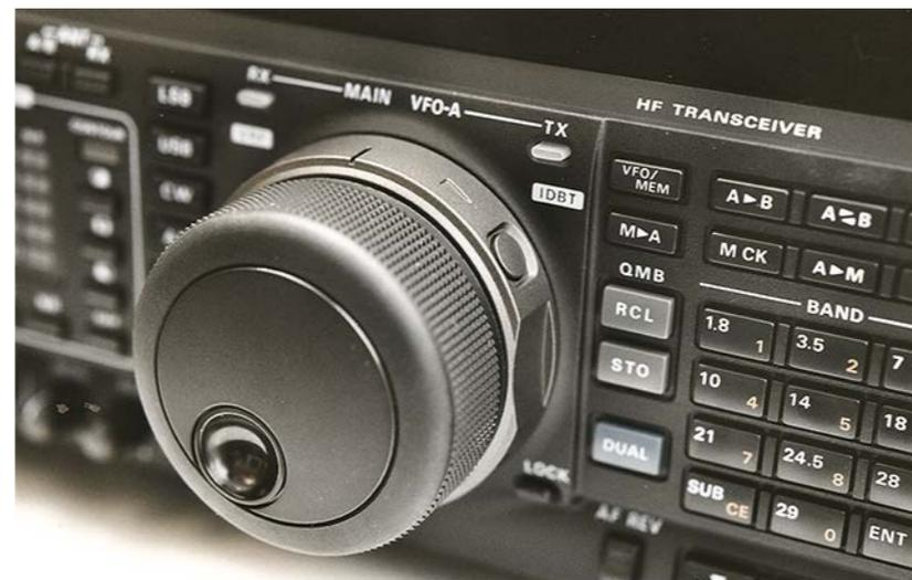
el desplazamiento y los rótulos de las funciones. La frecuencia se indica en resoluciones de 10, 100 o 1.000 Hz y el medidor de señal mide además de la intensidad de la señal recibida, el ALC, la compresión, las estacionarias y la potencia (con una calibración algo espectacular ya que llega hasta los 400 vatios).
