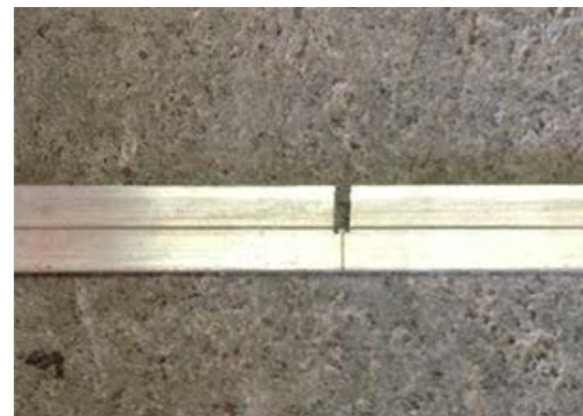
En el centro se hace una hendidura de 3 milímetros para el montaje del travesaño.
