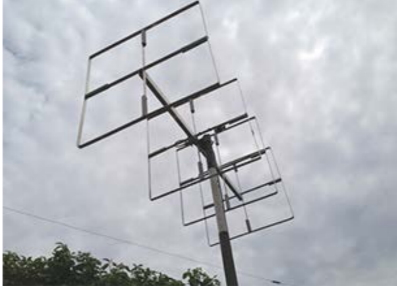
Tubos de PVC para los extremos de los largueros. Son restos de los que usan los electricistas.
