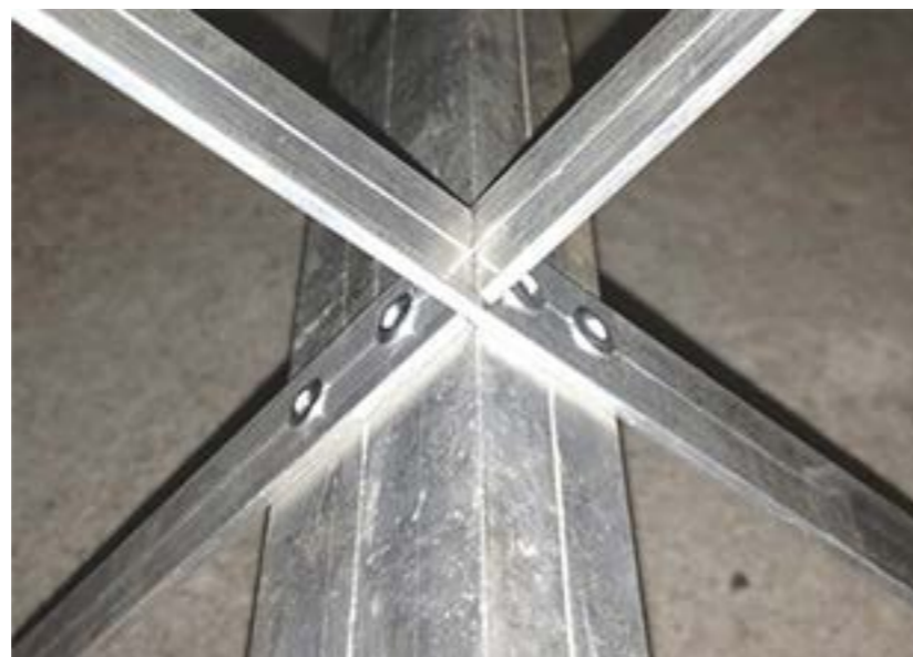
La fijación de los cuatro travesaños en el boom se hace mediante unos remaches, es la manera más simple y rápida de dejarlos bien colocados. Abajo, orificios para la coaxial en el elemento radiador.
