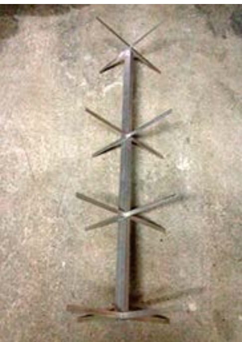
La fijación de los cuatro travesaños en el boom se hace mediante unos remaches, es la manera más simple y rápida de dejarlos bien colocados. Abajo, orificios para la coaxial en el elemento radiador.
