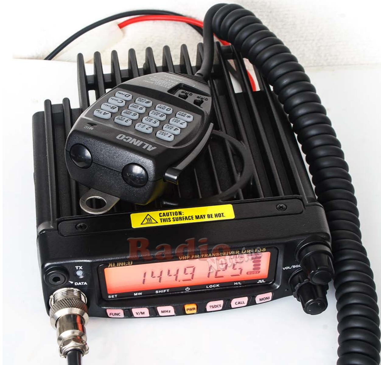
dígitos, pero presionando la tecla *MHz* se oculta la indicación de *KHz*. Volumen y silenciamiento tienen sus propios mandos giratorios, concéntricos y situados debajo del dial. Al umbral del *squelch* le medimos un valor de  $0,415 \mu\text{V}$ , mientras que la señal máxima que es capaz de enmudecer es de  $1,19 \mu\text{V}$ .
