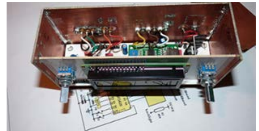
El Multi Rock II ya instalado en su caja, también de epoxy.
