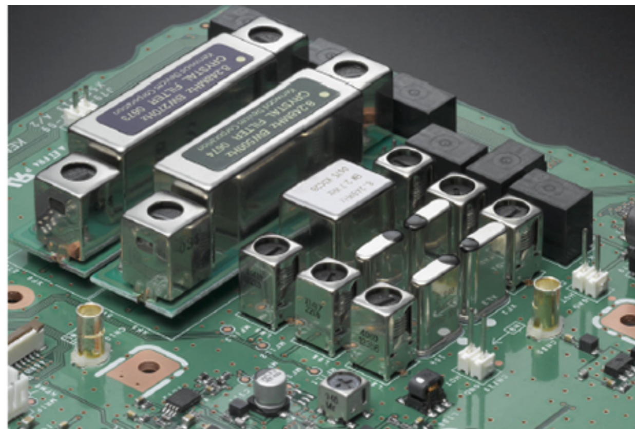
Filtros de techo del receptor principal.
