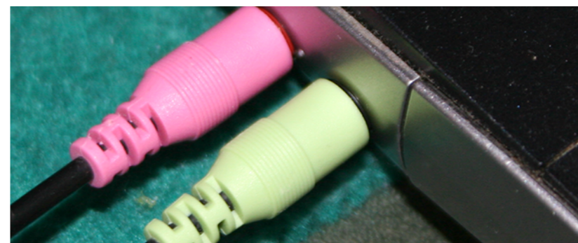
Tras comprobar que las conexiones están bien realizadas, en caso de que no llegue la señal al transceptor se desconectará la salida de audio (verde) para escuchar si realmente sale el sonido del ordenador.
