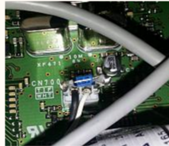
Detalles de la modificación y de los diodos necesarios para dotar de mayor empuje en transmisión al Kenwood TS-590S.
