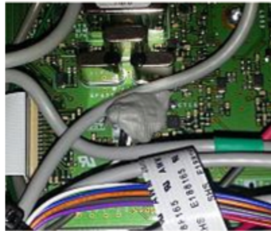
Detalles de la modificación y de los diodos necesarios para dotar de mayor empuje en transmisión al Kenwood TS-590S.
