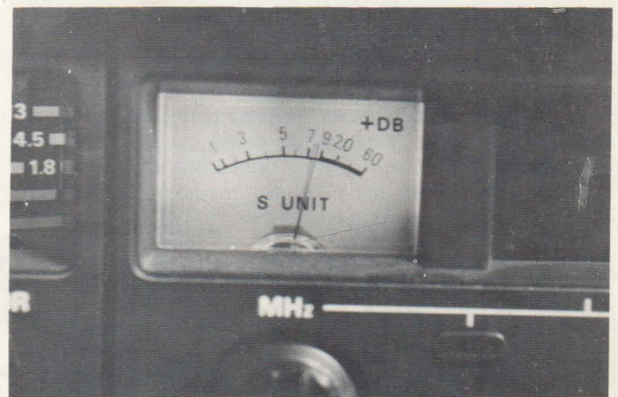
Figura 669. «S-meter», medidor de señales de recepción que generalmente llevan los equipos receptores de una cierta calidad para así poder apreciar los controles recibidos.
