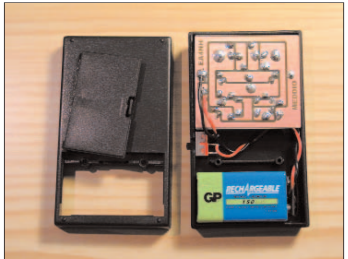
Figura 24: Colocación del circuito impreso.
