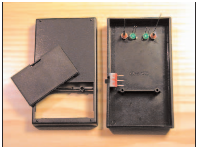
Figura 23: Puntos de prueba y diodos LED.
