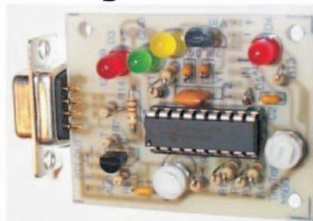
Modulo codificador de packet, permite la conexión del GPS al equipo de radio, para transmitir la posición en APRS. Configuración muy fácil mediante un simple programa Windows.
