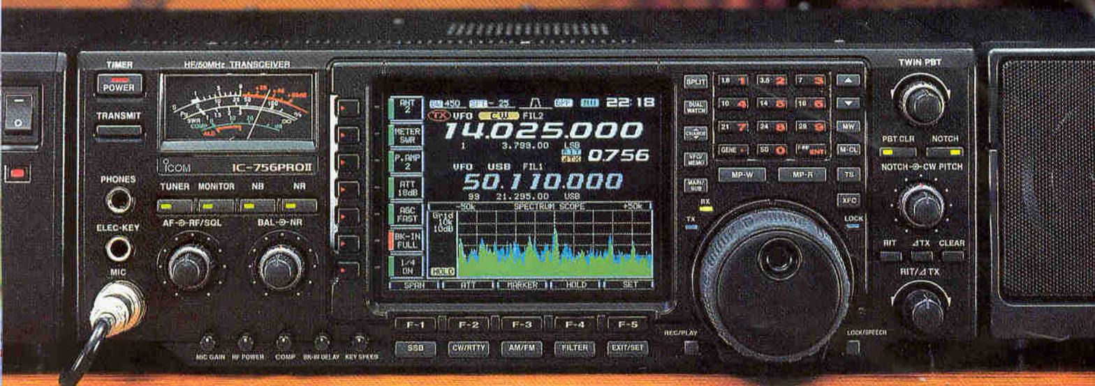
**DSP** La unidad DSP de 32 bit y coma flotante y el convertidor AD/DA a 24 bit permiten al usuario crear filtros personalizados a su estilo de tráfico y a las condiciones de la banda. Sus características de filtraje agudo y suave garantizan selectividad, limpieza y fidelidad en la reproducción de la señal.
