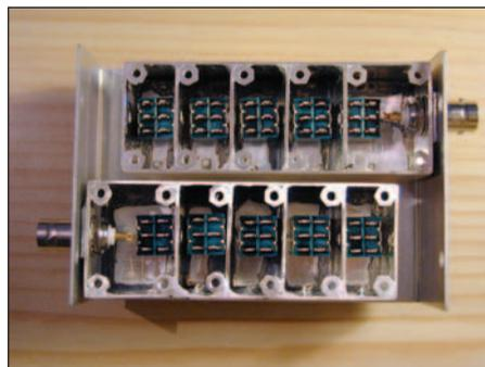
**Figura 10: Colocación de los conmutadores.**
