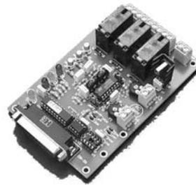
Sistema Universal de control de rotores de antena por ordenador
