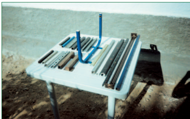
Foto 1: Barrotos empleados para formar un cuerpo de torre.
