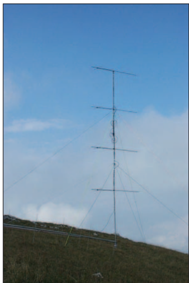
4x9 elementos Yagi sobre mástil de 13 metros.
