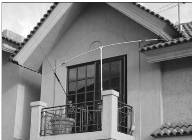
Figura 8: Antena vertical multibanda MP-1 y la Buddipole a la derecha.
