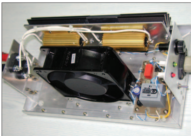
Figura número 15: Cableado de las cargas
