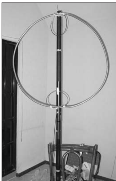
Figura 7: Antena magnética de aro (10-20m) dispuesta para trabajar como antena interior.
