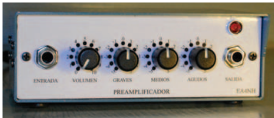
Figura número 10: Preamplificador terminado.
