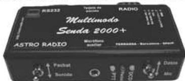
MÓDEM PACKET-RADIO + Adaptador tarjeta de sonido
