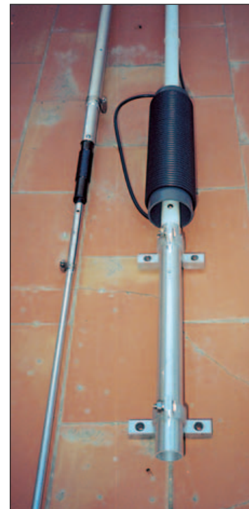
Aspecto del balun y del último tramo de la MA5V.
