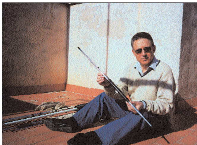
EA5ME muestra la varilla con las bobinas para 10 y 12 metros.
