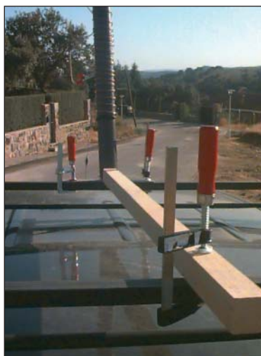
Foto 3: Sujeción de la bobina y mástil al coche con gatos.
