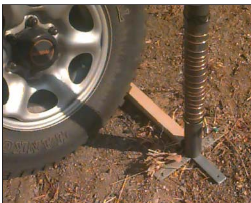
Foto 4: Sujeción del mástil pisando la cruceta con la rueda del coche.
