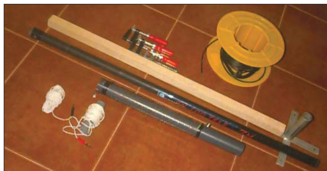
Foto 2: Elementos que componen la antena para 40 y 80.
