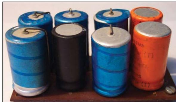
**Módulo de filtros de entrada +150v DC + filtros de salida de la self +150v DC**
