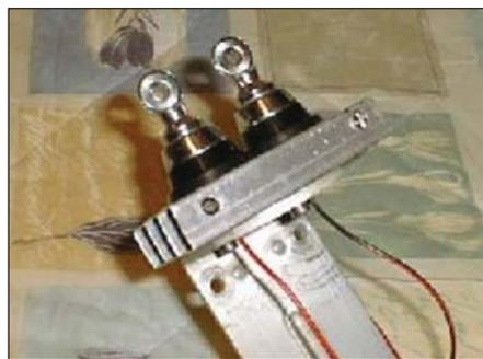
Aspecto de los soportes de las antenas montados en los cuadradillos de aluminio, junto con sus cables de conexión.
