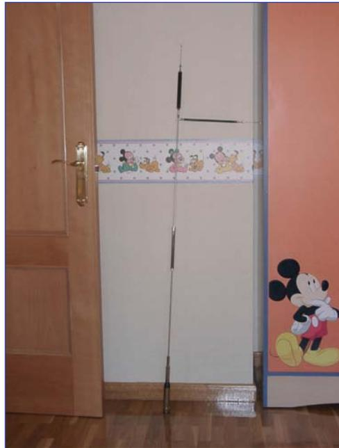
La antena con las bobinas de 20 m (vertical) y 15 m (horizontal)
