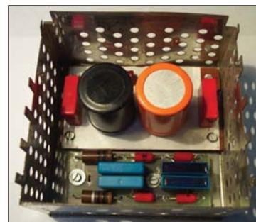
**Módulo de filtros +600v DC y módulo rectificador +300v DC, montados**
