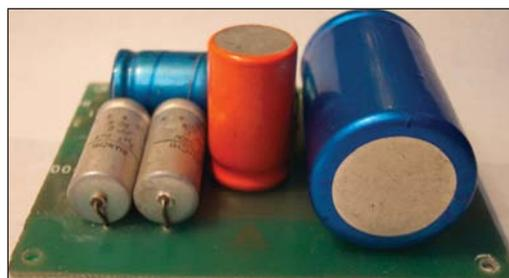
**Módulo de filtros del +300v DC a la salida de la self**
