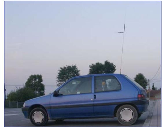
La antena instalada en el coche con las bobinas de 40 m (en vertical) y 20m (en horizontal).
