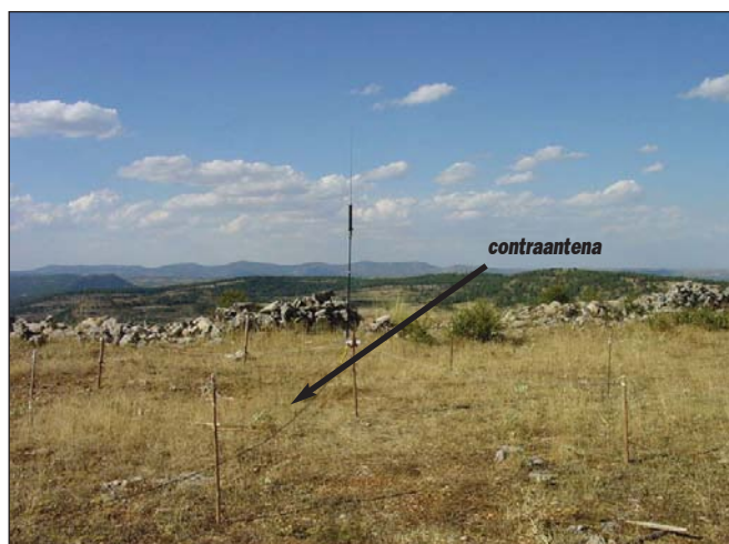
Fig 14. Pruebas con la MP-1 en el campo con los radiales a 0,5 m de altura así como con la contraantena.
