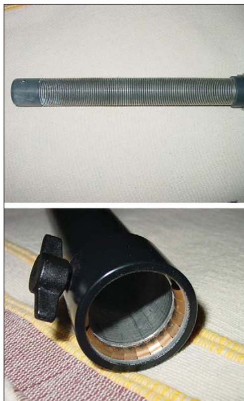
Fig 10. Aspecto de la bobina y boquilla del capuchón que es la que “cortocircuita” las espiras de la bobina y forma parte del elemento radiante para las bandas más bajas.
