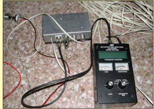
Foto 8: Vista general del conmutador montado y en pruebas para determinar el "efecto de la frecuencia sobre la ROE", a la derecha el analizador MFJ-259B, usado para el análisis.
