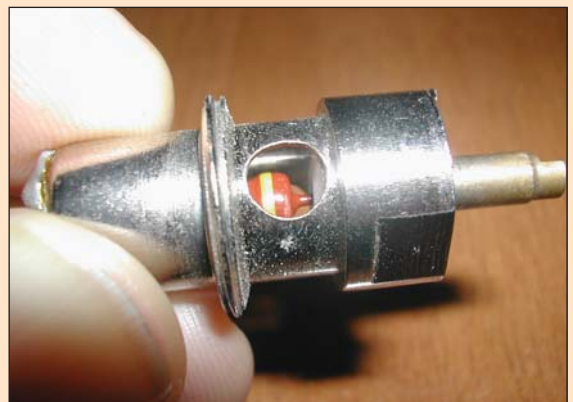
Foto 10: Detalle de la carga fantasma, sencilla y muy "QRP".
