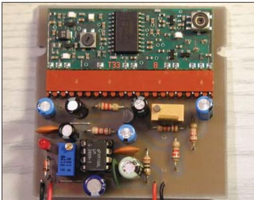
**Figura número 25: Circuito impreso del receptor con componentes.**
