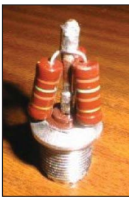
Figura 4: Las tres resistencias que forman la carga de 50 ohmios se deben montar en un conector PL hembra tal y como muestra la imagen.
