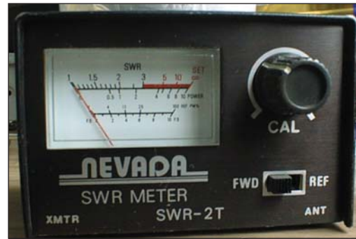
Figura 1: El vatímetro está basado en un medidor de ROE muy común en el mundo de la banda ciudadana, y muy barato también.
