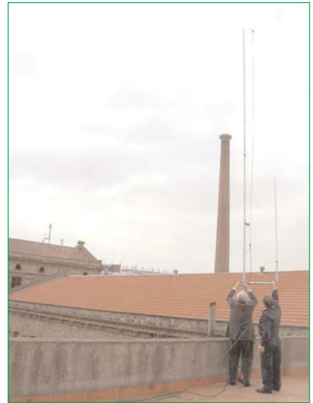
Una sencilla G5RV corta y una colineal bibanda bastaron para demostrar las capacidades de una instalación moderna de radioaficionado.
