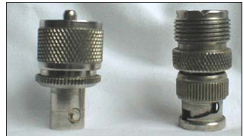
Figura 7: Detalle de los dos adaptadores medidos con el nuevo vatímetro: Sus pérdidas se sitúan en torno a los 1.1 dB para cada uno en 144 MHz.
